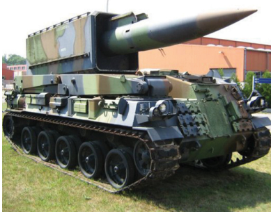
2.15 pav. Prancūzų taktinė branduolinė raketa „Plutonas“ (apie 1970 m.), galinti iššauti 120 km atstumu 15 kilotonų branduolinį užtaisą (Pluton 034.jpg, CC BY-SA 2.0 fr)
