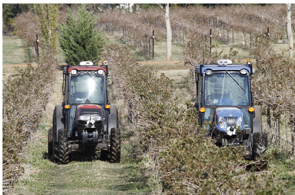
5.32 pav. Savarankiškai dirbantys traktoriai purškia vynuogynų plantacijas (Autonomous compact tractors in a Texas vineyard, Nov 2012.jpg, CC BY-SA 3.0)
