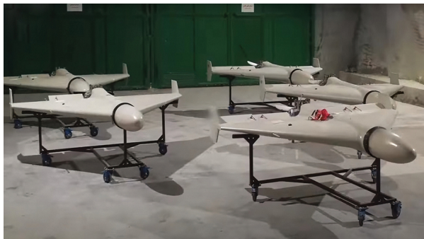
5.10 pav. Irano gamybos „savižudžiai“ dronai „Shahed-136“: masė – 200 kg, kovinės galvutės svoris – 30–50 kg, veikimo diapazonas – 1 800–2 500 km, maksimalus greitis – apie 185 km/h (Shahed136lm.png. CC BY-SA 4.0)
