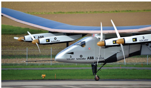
5.45 pav. Pirmasis saulės energija varomas orlaivis „Solar Impulse 2“, 2016 m. užbaigęs skrydį aplink pasaulį (Solar Impulse S12 pilote Bertrand Piccard Payerne November 2014.jpg, CC BY-SA 4.0)
