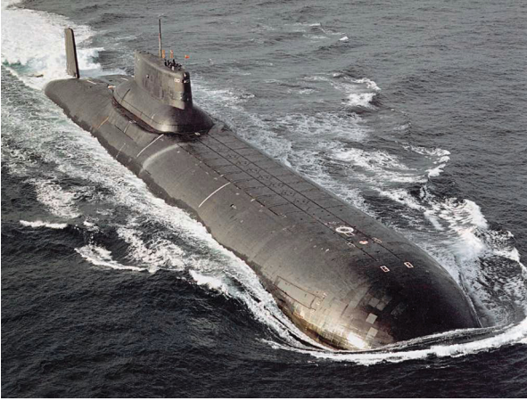
2.19 pav. Branduolinio reaktoriaus varomas „Akula“ klasės (Rusija) laivas yra didžiausias pasaulyje povandeninis laivas. Paniręs jis gali plaukti 50 km/h greičiu (Pike, J., 2000; Typhoon3.jpg. Creative Commons CC0 License)
