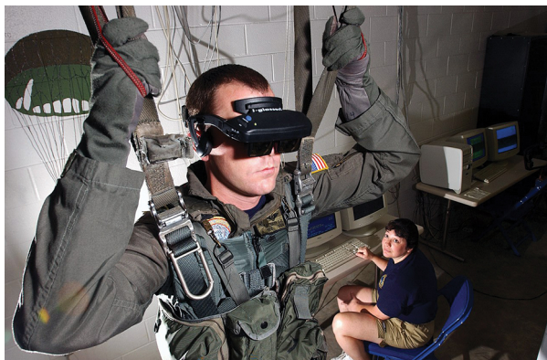
5.25 pav. Nusileidimo parašitu simuliacija, pasitelkiant virtualiosios realybės akinius (VR-Helm.jpg. Viešo naudojimo)
